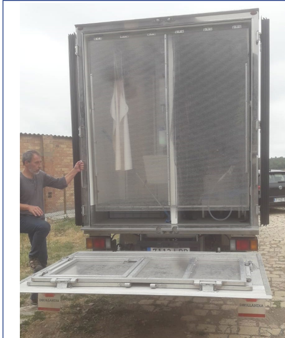
Fotografía 2: Vista trasera del matadero móvil, con la plataforma de la zona exterior descendiendo y el techo sin elevar.
