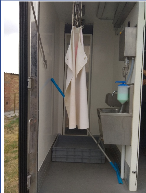
Fotografía 6: Vista de la zona sucia, equipada con lavabo, esterilizador de cuchillos, ganchos para la suspensión del animal y balde para la recogida de sangre.
